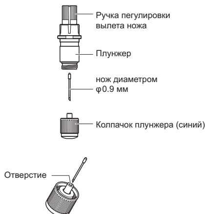
Плунжер для ножей φ0.9 мм
