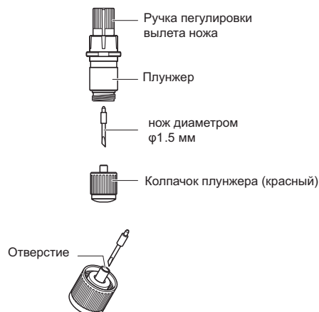
Плунжер для ножей φ1.5 мм
